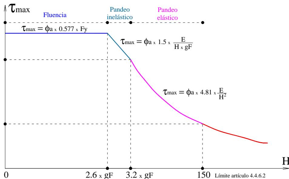
$gF =$  Función característica de tensiones  $= \sqrt{\frac{E}{F_y}}$  - (Referida a la tensión de fluencia)
