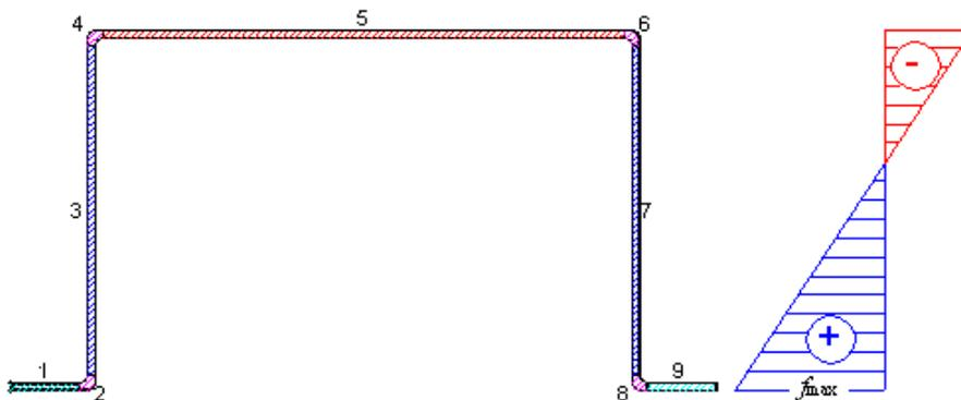
Las tensiones de flexión, en ningún elemento de la sección superarán el valor:
